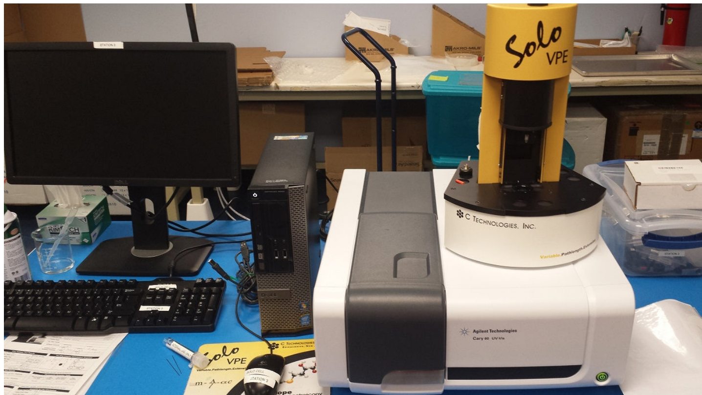
付属 PC、SoloVPE 本体、分光器、付属品など(設置スペース幅 1m、奥行 60cm 程度)
