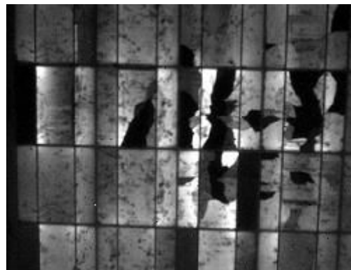
太陽電池表面の撮影(欠陥)
