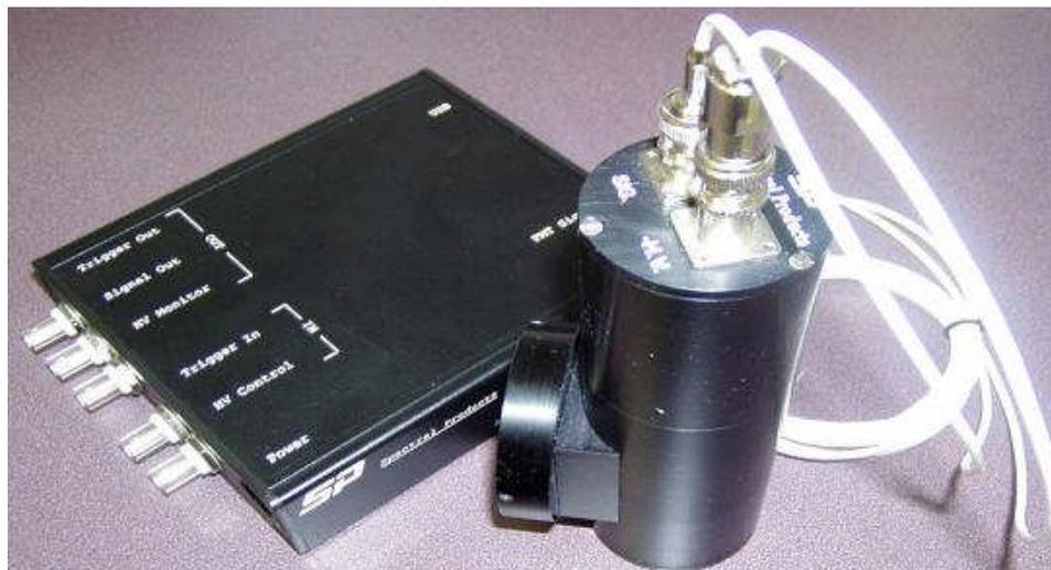
AD111は、パソコン制御のPMT(光電子増倍管)検出システムです。PMT用のプリアンプおよび高圧電源が内蔵され、モノクロメータ出射スリットに簡単に接続できます(PMTは別売)。波長・バンド幅の選択も含め、パソコンですべての操作が可能です。PMT・モノクロメータ制御ソフトも含まれており、波長-強度、強度-測定時間などスペクトル表示したり、テキスト形式で保存したりできます。
